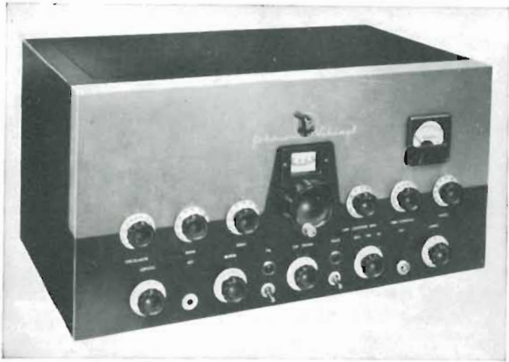
Fig. 9.1. - Aspetto di tipico trasmettente da 100 watt fonica. L'apparecchio è provvisto di un solo strumento di misura, nei diversi circuiti mediante un commutatore.
