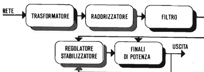
Fig. 6.17. - Schema a blocchi di alimentatore stabilizzato.
