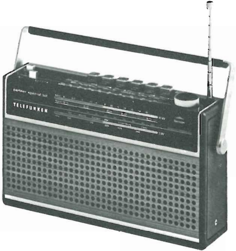
Fig. 3.2. - Apparecchio radio portatile a modulazione di frequenza, onde medie, onde lunghe e onde corte dei 49-19 m (Telefunken Partner Special 101).
